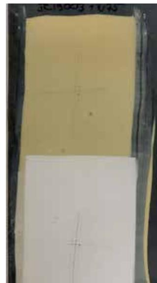
Recouvrabilité du primaire par une finition polyuréthane.
