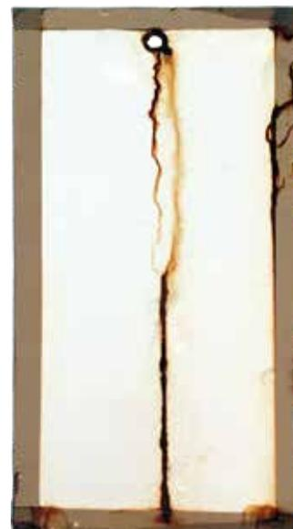
**Résistance au brouillard salin 959 h
