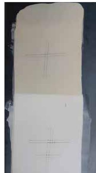
Recouvrabilité du primaire par une finition polyuréthane.
