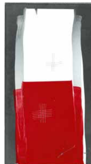
Recouvrabilité du primaire par une finition polyuréthane.
