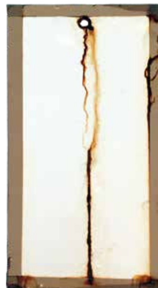
Résistance au brouillard salin 959 h d'un film d'une épaisseur de 85 µm.
