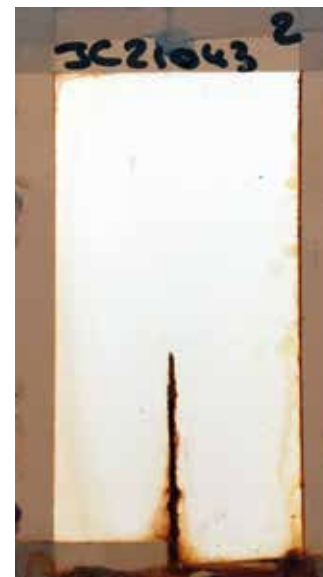
Résistance au brouillard salin à 1 000 h d'un film d'épaisseur de 100 µm.
