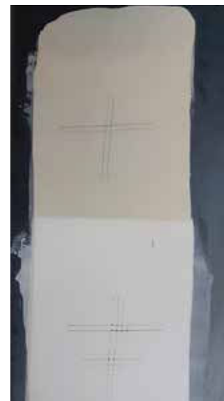
Recouvrabilité du primaire par une finition polyuréthane.
