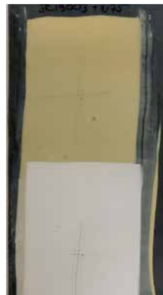
Recouvrabilité du primaire par une finition polyuréthane.
