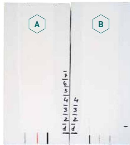
Test d'opacité entre une peinture classique acrylique (A) et la peinture mate chaulée isolante sur base **LIXOMAT 35 D60** (B)
